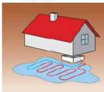
Tepelné čerpadlo nemrznoucí kapalina/voda - výměník naplněný nemrznoucí směsí ochlazuje půdu ve vrtu nebo ve výkopu, případně vodu ve vodním toku nebo v rybníku. © EkoWATT
