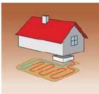
Tepelné čerpadlo nemrznoucí kapalina/voda - výměník naplněný nemrznoucí směsí ochlazuje půdu ve vrtu nebo ve výkopu, případně vodu ve vodním toku nebo v rybníku. © EkoWATT
