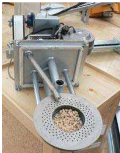
Hořák kotle na peletky (lze vmontovat i do kotlů na jiné palivo). Foto: EkoWATT
