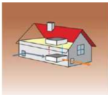
Tepelné čerpadlo vzduch/voda - ochlazuje se vzduch odváděný větracím systémem. © EkoWATT
